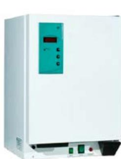
Подвергнутые импакции агаризованные чашки Петри и стрипы инкубируют в термостатах при соответствующей температуре с естественной или принудительной (желательно, регулируемой) конвекцией; объем аппаратов от 10 до 1000 л; производители: Россия, **Binder**, **PHCbi (Panasonic/Sanyo)**, **Thermo**.
