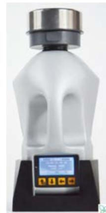
**RCS High Flow Touch, Merck** – универсальный импактор для контроля атмосферного воздуха и сжатых газов; вместо чашек Петри – гибкие пластиковые стрипы со средой; оригинальная конструкция обеспечивает низкую турбулентность воздушного потока и равномерную импакцию микроорганизмов на агаризованной поверхности стрипа. При отборе сжатого газа применяют конусовидный адаптер, замедляющий скорость его поступления в импактор.
