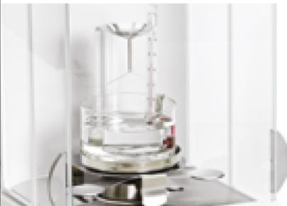
Определение плотности становится легким благодаря комплекту для определения плотности. Комплект подходит для работы с твердыми, жидкими и вязкими образцами.
