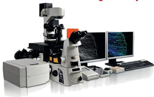
Мультифотонные микроскопы серии **A1R MP** оборудованы современнейшими четырёхканальными приёмниками, которые обладают повышенной чувствительностью при невысоком темновом токе и широком волновом спектре.
