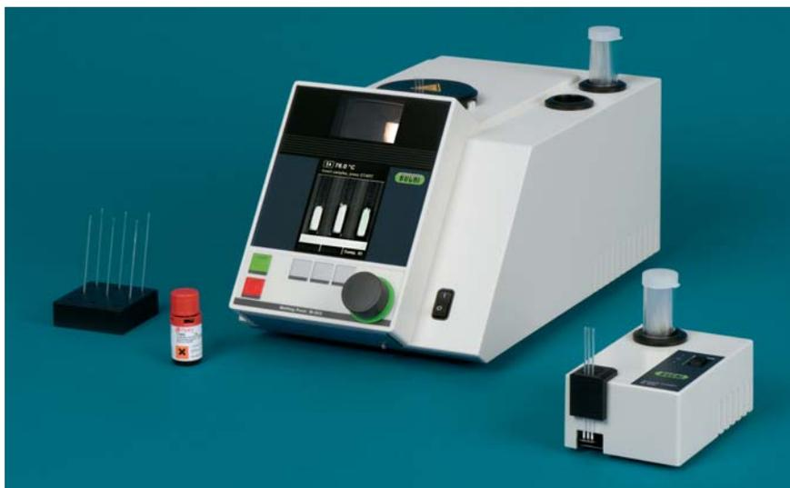
«Профессиональный» комплект включает: M-565, устройство для заполнения капилляров M-569, 100 капилляров для определения Тпл, 10 пробирок для определения Ткип, набор образцов для калибровки, подставка для заполненных капилляров, проволочка для уплотнения набивки капилляров, устройство для очистки нагревательного блока.
