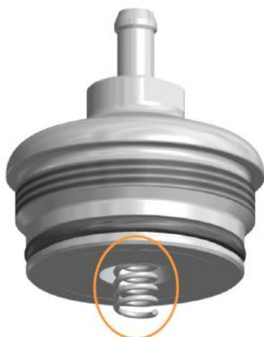
Крышка клапана снята. Прижимная пружина автоматически поднимается от центрирующего кулачка поршня клапана внутри цилиндра под действием кольцевого магнита, встроенного в крышку клапана.
