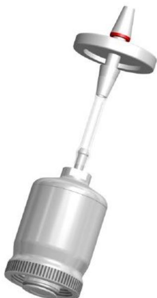
3. Присоедините впускной воздушный фильтр (начальный комплект) к шлангу. Красная метка на одноразовом фильтре находится со стороны фильтра, обращенной в противоположную от нажимного клапана сторону.
