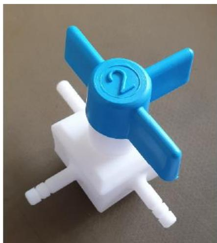
Для асептического отбора проб во время культивирования через трубку используется пробоотборник «Super Safe». Таким образом, систему отбора проб можно присоединить к трубке для отбора биомассы и к оборудованию с помощью шланга; трехходовой кран и кусок силиконового шланга, Ø = 3 x 6 мм (10 см) входят в комплект.
