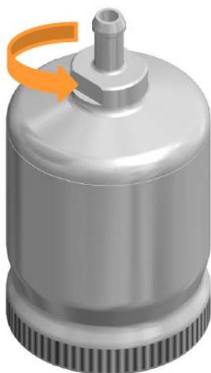
1. Плотно удерживая цилиндр клапана рукой, отверните крышку клапана, вращая против часовой стрелки рожковым ключом.
