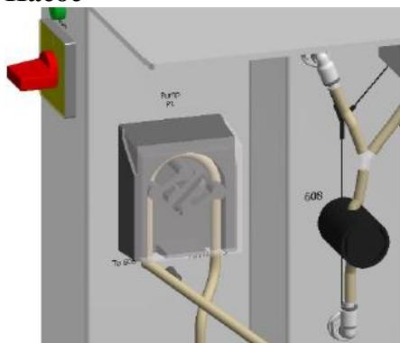
На левой стенке корпуса расположен перистальтический насос для циркуляции воды в процессе очистки/стерилизации на месте. Насос приводится в действие шаговым двигателем и в автоматическом режиме вращается по часовой стрелке или против часовой стрелки в зависимости от последовательности процесса. Насос также можно запустить вручную кулисным выключателем над ним, когда оборудование включено:
