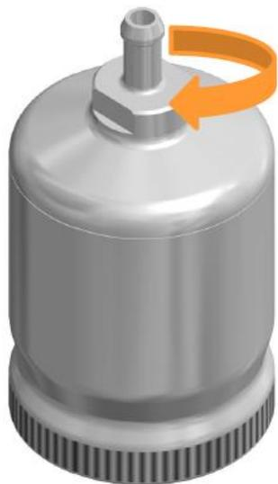
4. Плотно удерживая цилиндр клапана рукой, заверните крышку клапана, вращая по часовой стрелке рожковым ключом.
