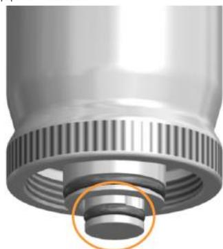
1. Вставьте поршень клапана в цилиндр клапана и полностью протолкните, чтобы поршень выступал из цилиндра.
