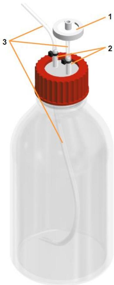
Две бутылки для реактивов объемом 1000 мл из боросиликатного стекла предназначены для добавления кислоты и основания в процессе очистки/стерилизации на месте. Бутылки для реактивов снабжены одноразовыми фильтрами и силиконовыми шлангами.
