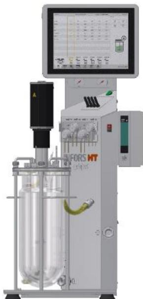
Весь процесс очистки и стерилизации на месте управляется с панели управления биореактора Labfors 5. Функции LabCIP уже встроены в программное обеспечение биореактора при доставке оборудования.
