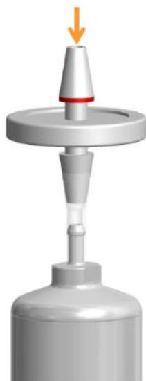
7. Подсоедините свободный конец шланга к впускному воздушному фильтру на нажимном клапане распылителя.
