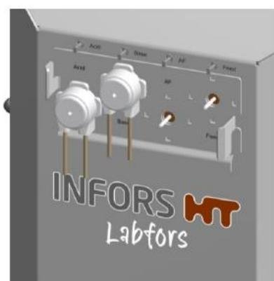
14. Прикрепите установочную пластину с головками насосов к валам привода насосов для добавления кислоты и основания на основном блоке биореактора.
