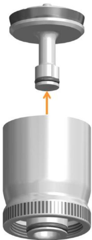
3. Палочкой протолкните поршень клапана достаточно глубоко в цилиндр клапана, чтобы он вышел и его можно было извлечь из цилиндра.
