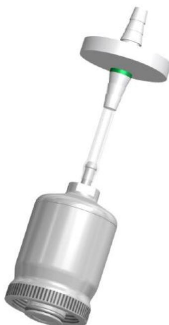
4. Убедитесь, что нажимной клапан охладителя выходящего газа правильно подсоединен к шлангу и выпускному газовому фильтру; подсоедините их при необходимости. Зеленая метка на одноразовом фильтре находится со стороны фильтра, обращенной к нажимному клапану.
