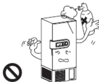
Не направляйте на прибор прямую струю воды. Не используйте проволочную или жесткую щетку для очистки прибора.
