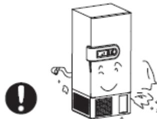
Для более эффективного охлаждения чаще мойте конденсатор воздуха, трубки охлаждения и компрессоры.
