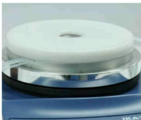
Адаптер-держатель интерфейса Н для нагревательной плитки и тефлоновая крышка адаптера
