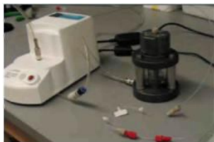
Институт Висса: Эксперимент с перекачиванием жидкости под действием вакуума
