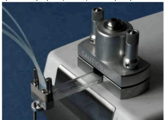
Изготовленный по заказу микрофлюидный чип, нагретый до 500°C с одного конца и охлажденный до 100°C с другого.
