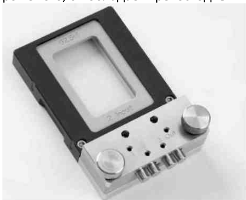
Чип-микрореактор с держателем и коннектором
