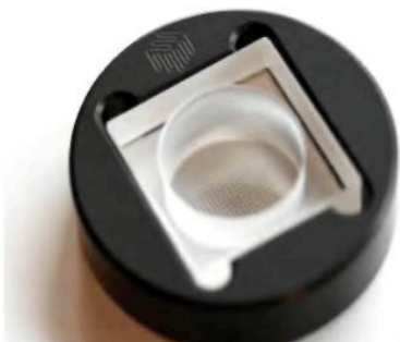
Чип для иммобилизации эмбрионов и адаптер
