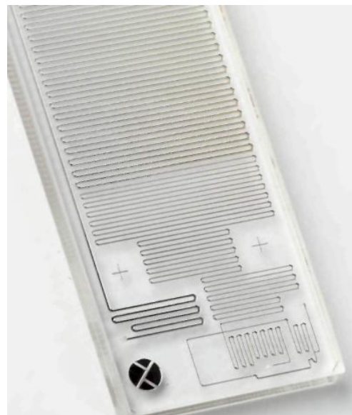
Чип-микрореактор 62,5 мкл с металлическим покрытием
