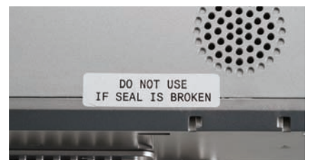
Материалы контроля вскрытия
