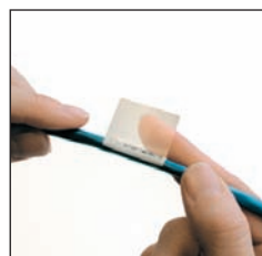
Прозрачную часть этикетки обернуть вокруг провода, перекрыв область с текстом
