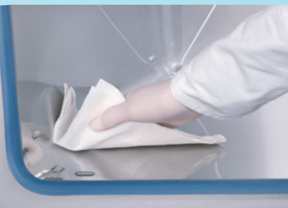
Микробиологические инкубаторы Heratherm имеют гладкую внутреннюю камеру с закругленными углами, что облегчает чистку
